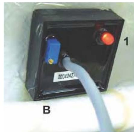
Dans une atmosphère humide et sans présence d'eau dans la baignoire, le détecteur peut être constamment allumé. A l'inverse dans une atmosphère sèche le détecteur peut ne pas détecter la présence d'eau dans la baignoire. Il faut alors procéder au réglage.
